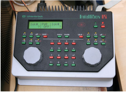
Pienoisrautatietohjain, kuten kuvan IntelliBox, mahdollistaa pienoisrautatien ohjaamisen sekä sillä itsellään että tietokoneen kautta.
